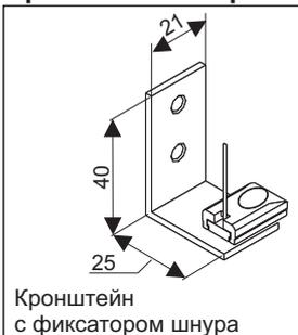
Кронштейн с фиксатором шнура
